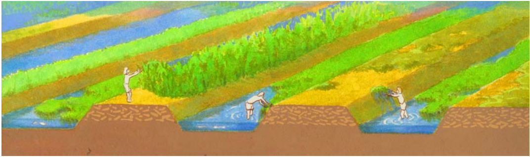
FIGURA 7.1 Esquema del funcionamiento de los campos elevados
